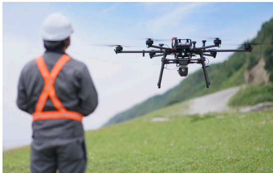
高精度レーザースキャナーを搭載したドローンを用いて測量を行うことで地形を正確に短期間でデータ化する
