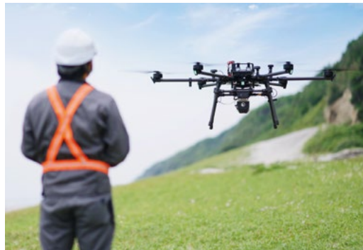
高精度レーザースキャナ搭載のドローンを用いたイクトの測量法。短期間で地形を正確に把握できる
